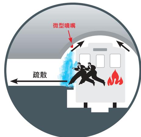
SEM-SAFE® 微型噴嘴可形成水幕，使毒氣體濃度得到有效控制，同時進行冷卻。
